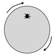
Um besouro se apoia na superfície de uma plataforma que gira no sentido **anti-trigonométrico** ( $\vec{\Omega} = -\Omega \hat{z}$ .) O besouro sofre a ação de uma **força de atrito**, com coeficiente estático  $\mu_S$ . (Isto significa que não podemos mais ignorar as forças normais! O campo gravitacional usual  $\vec{g}$  aponta para dentro do papel.)
