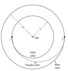
A figura mostra uma órbita de transferência de Hohmann entre as órbitas da Terra e de Marte.
