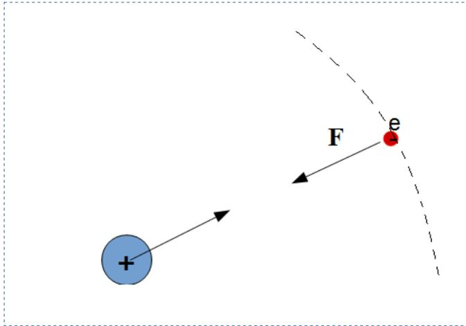
Para um campo de força central e se a órbita for circular, a força elétrica igual a centrípeta nos diz que :
