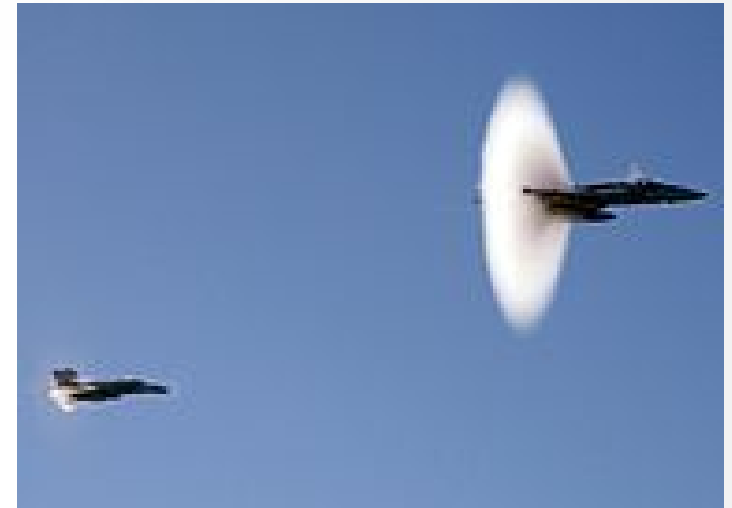
onda de choque em um avião supersônico
