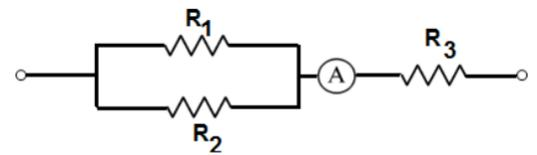
11) Se as correntes nos resistores  $R_1$  e  $R_2$  têm o mesmo valor,  $I_1 = I_2 = 2A$ , os valores de  $R_1$  e  $R_2$  são:
