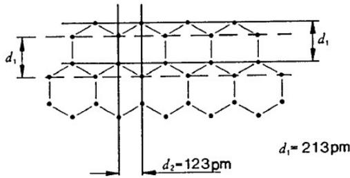
**Figura 6:** Planos do grafite que correspondem aos dois anéis principais.
